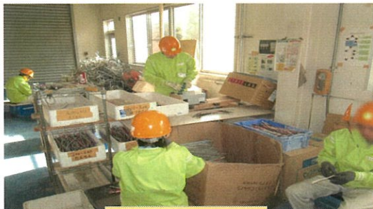
銅線の被覆剥ぎ
